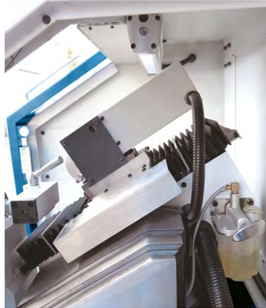
Schrägbettbauweise für optimierten Arbeitsraum und Späneabfuhr
