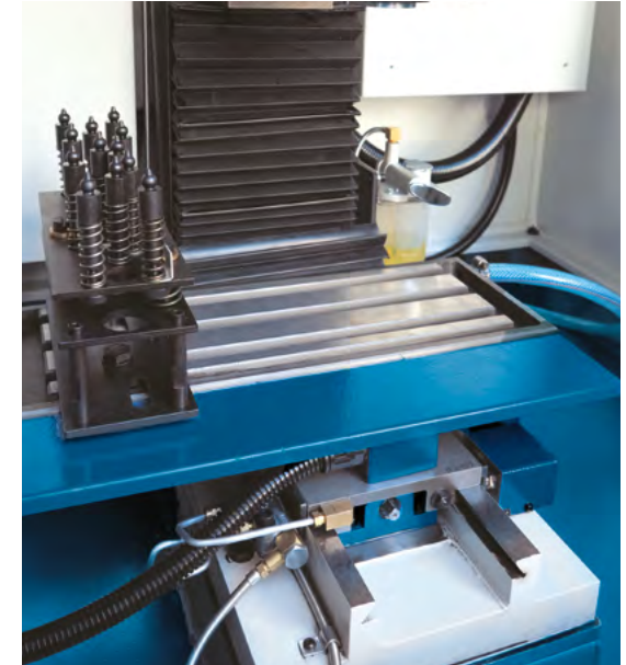
präzise einstellbare Schwalbenschwanzführung
