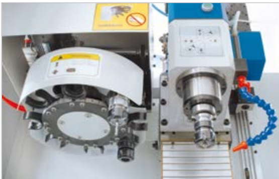
Automatisierung steigert die Produktivität - serienmäßiger 8-fach Werkzeugwechsler für MAS BT 30 Werkzeuge
